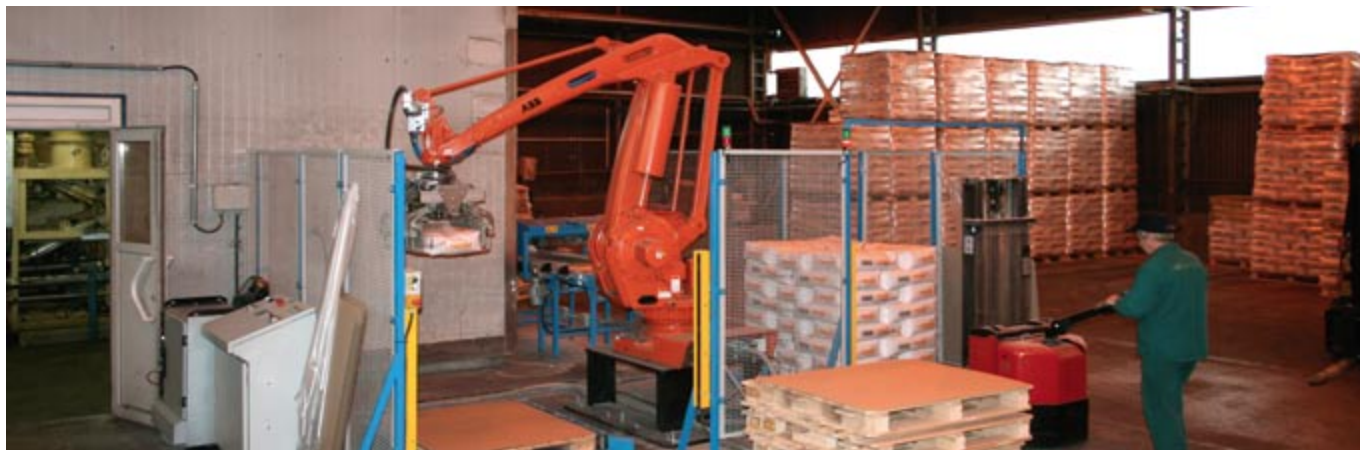
Kým obsluha odoberá naloženú paletu, robot bez prestojov pokračuje v ukladaní vriec na vopred pripravenú paletu na druhej strane.
