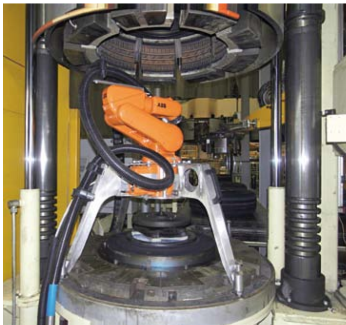
2 Robot založený do lisu pred čistením
