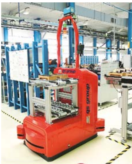
1 AGV zariadenie nazvané „Ferrari“
