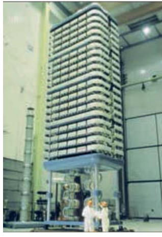
รูปที่ 6 การทดสอบวาล์วที่ 600kV สำหรับ Itaipu
