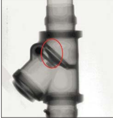
รูปที่ 7 เสื่อวาล์ว บิดไม่สนิท ต้องการซ่อมบำรุง
