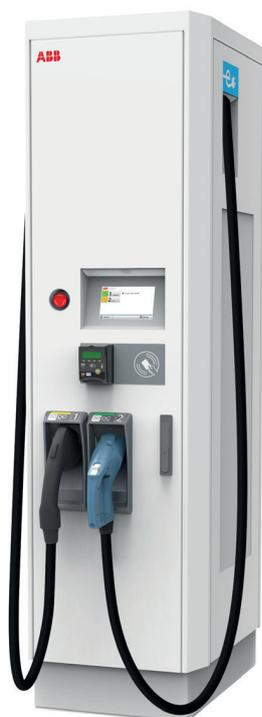
Basándose en una década de experiencia en carga rápida de vehículos eléctricos, Terra 54 de ABB se une a la familia Terra de estaciones de carga rápida de DC más vendidas para mejorar la facilidad de uso y la fiabilidad. Terra 54 permite una carga continua de 50 kW hasta 500 V, mientras que Terra 54HV soporta entre 200 y 920 V.
