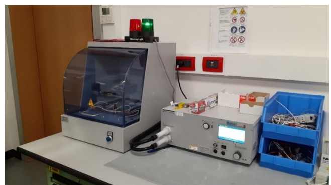
Fig.18 Envolvente de prueba con sistema de enclavamiento automatizado
