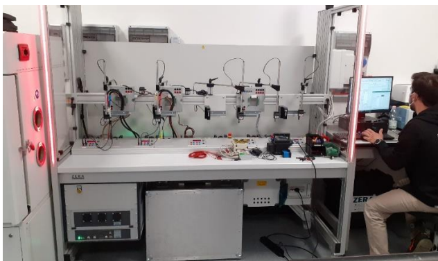
Fig. 17 Banco de pruebas abierto equipado con sistema de enclavamiento láser
