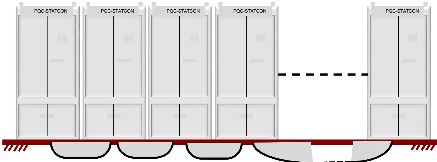
En sistema paralelo de PQC-STATCON, la fiabilidad del sistema se incrementará en "X" veces, a diferencia de otros sistemas MASTER-SLAVE donde, en caso de fallo maestro, el sistema total se apaga. En PQC-STATCON todos los modulos individuales son capaces de ser un maestro y asumirán el control cuando sea necesario
