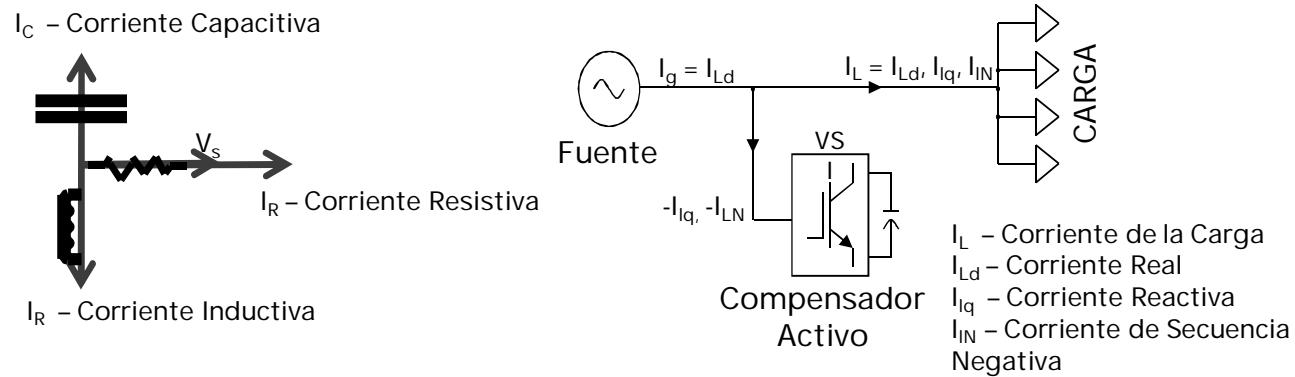
Técnica de compensador de energía reactiva basada en compensador activo
