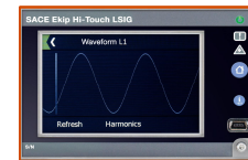
▪ EKIP HI-TOUCH: Ekip Touch + protecciones avanzadas, Monitoreo Power Quality
