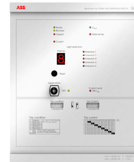
Unidad electrónica de detección y disparo (DTU) tipo QRU1
