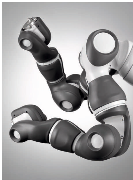
YuMi® cuenta con brazos acolchados que se detienen de inmediato si se produce un contacto inesperado.
