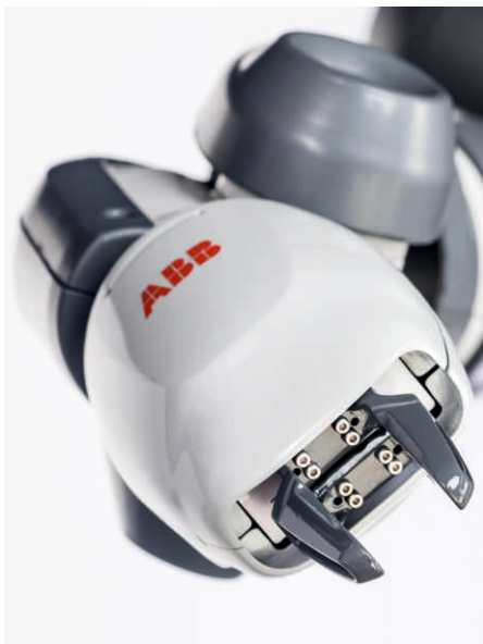
YuMi® admite pinzas preparadas para la visión, ventosas simples y dobles y servoasistidas.
