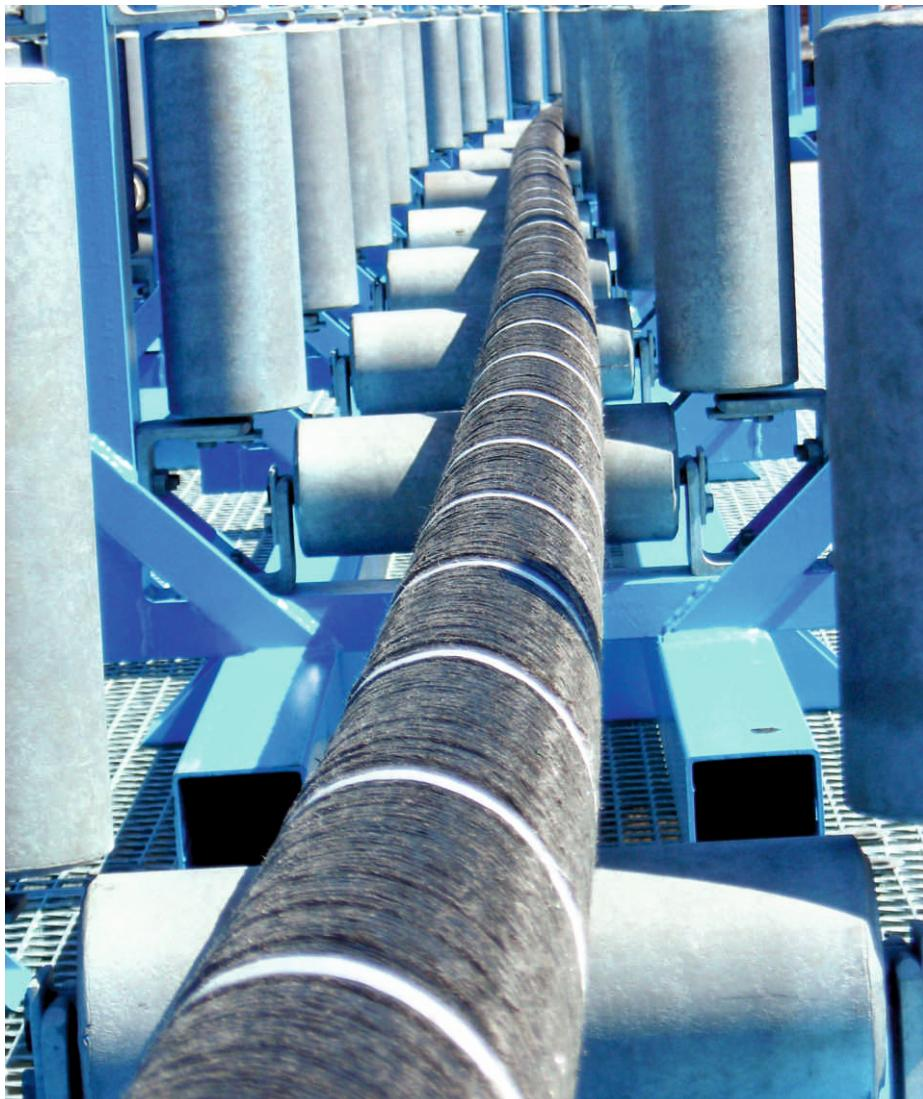
El sistema de cables, con una potencia de 600 megavatios (MW), permitirá el transporte de la energía generada por el mayor parque eólico de Dinamarca hasta tierra firme.
