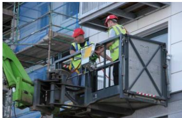
Fig 8 ROLT equipada con una Plataforma de Trabajo Integrada
