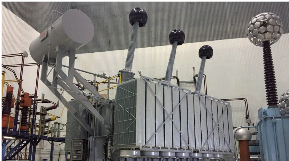
Transformador Trifásico de 335 MVA - 230 kV construido en la fábrica de ABB en Guarulhos, Brasil.
