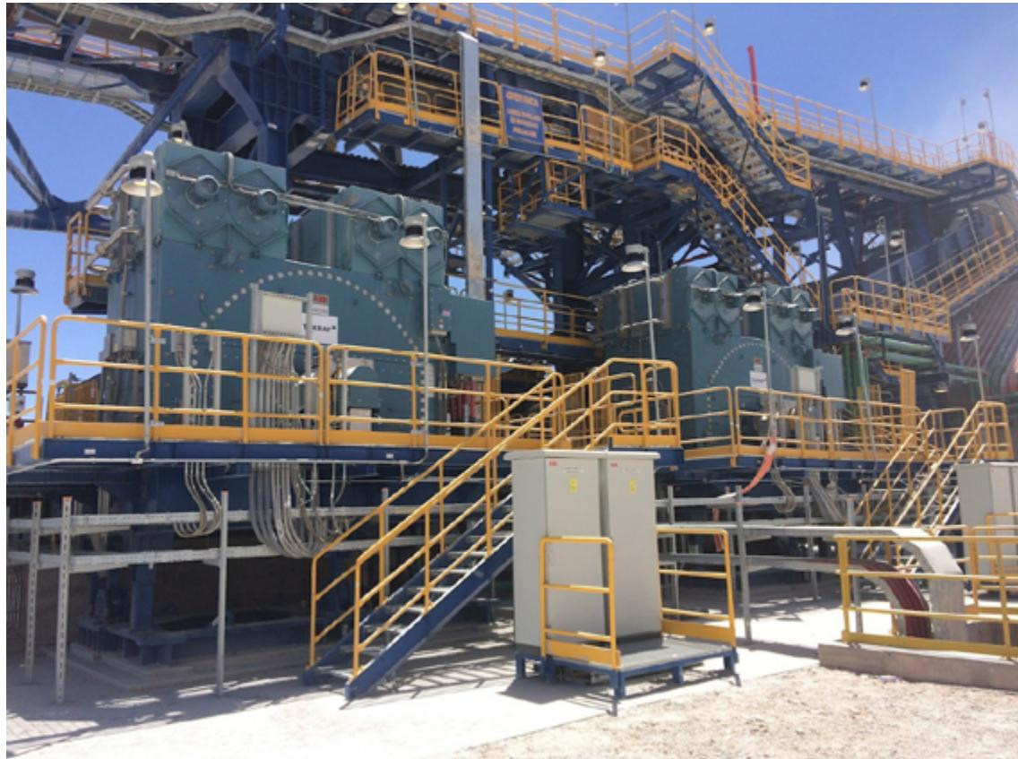
GCD existentes en la construcción en balancín. La concepción también significaba que los motores eran 100% montados y probados en fábrica: ellos pueden ser desconectados mecánicamente de la polea de transmisión, de manera rápida, para que las operaciones sigan su curso aunque ocurra una falla de transmisión.
