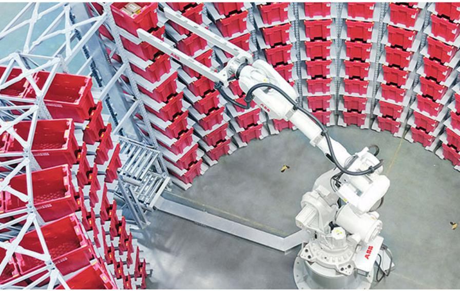
El FlexBuffer™ es una célula modular, que ofrece funcionalidades adicionales a los sistemas de almacenaje automáticos convencionales. El robot está en el corazón del sistema, convirtiéndolo en una alternativa fiable y con poco mantenimiento
