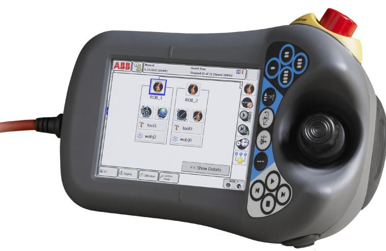
Ce stage de programmation a été préparé par ABB pour apprendre à configurer les fonctionnalités de la carte de sécurité "SafeMove2", d'interpréter la signalisation de défauts et de réinitialiser la synchronisation de la carte.
