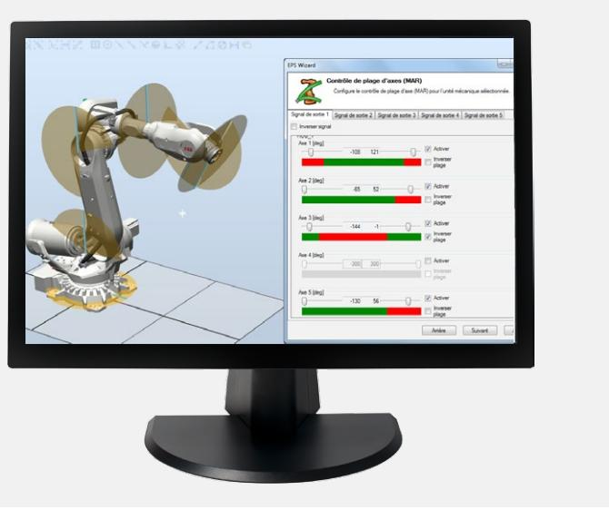
Ce stage de programmation a été préparé par ABB pour apprendre à configurer les fonctionnalités de la carte de sécurité EPS (Electronic Position Switch) d'interpréter la signalisation de défauts et de réinitialiser la synchronisation de la carte.
