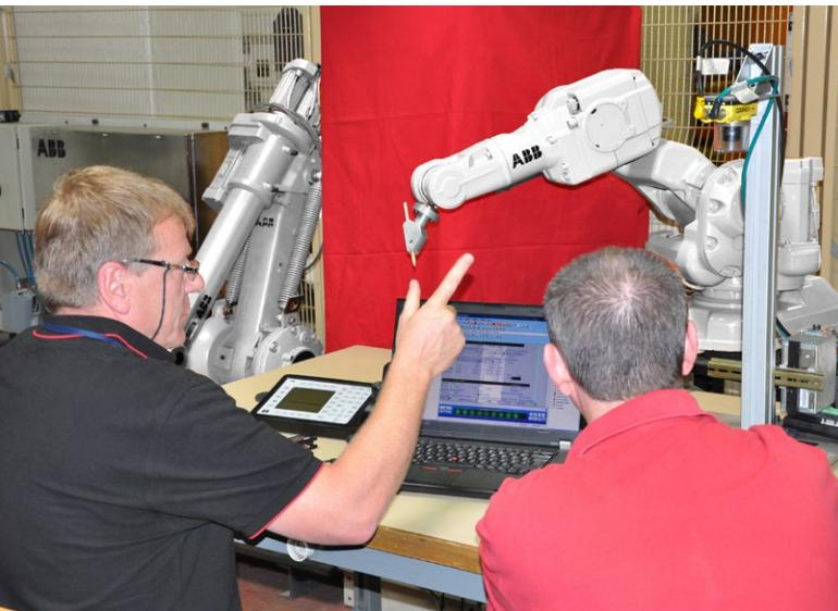
Ce stage de programmation avec un système de vision est développé et proposé par ABB. Il permet aux participants d'intégrer au robot un ou plusieurs systèmes de vision In-sight de Cognex et de finaliser la programmation pour gérer la communication avec la caméra par Ethernet.
